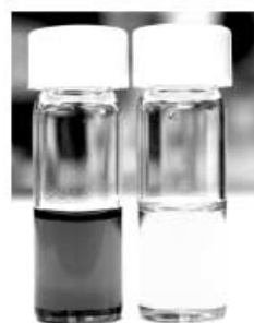
Schema 44. Der erste wiederverwendbare und trägerfixierte chirale Katalysator zur Olefinmetathese liefert Reaktionsprodukte, die erheblich weniger metallische Verunreinigungen enthalten. Die beiden Proben enthalten das ungereinigte Produkt aus einer Reaktion mit 11a (links) und 103 (rechts) als Katalysator.
